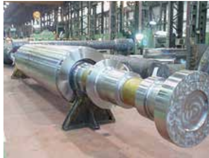
Generator rotor shaft Eje generador diesel
