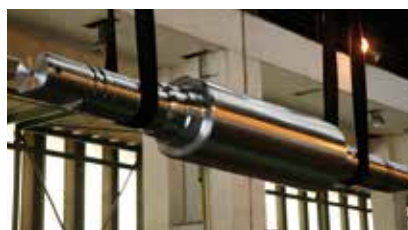
Work roll 3%Cr - 5%Cr Cilindro de trabajo 3%Cr - 5%Cr
