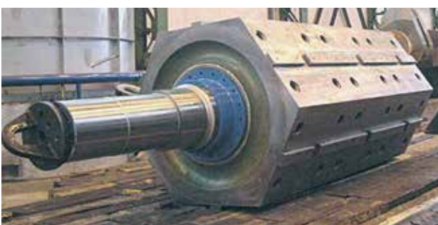
Roll crusher with shrunk shaft (oil sands) Cuerpo de giro con eje zunchado (arenas bituminosas)
