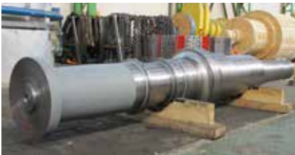
Generator shaft Eje generador
