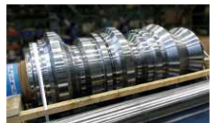
Rolls for long product mills 3%Cr - 5%Cr Cilindros para laminación de productos largos 3%Cr - 5%Cr
