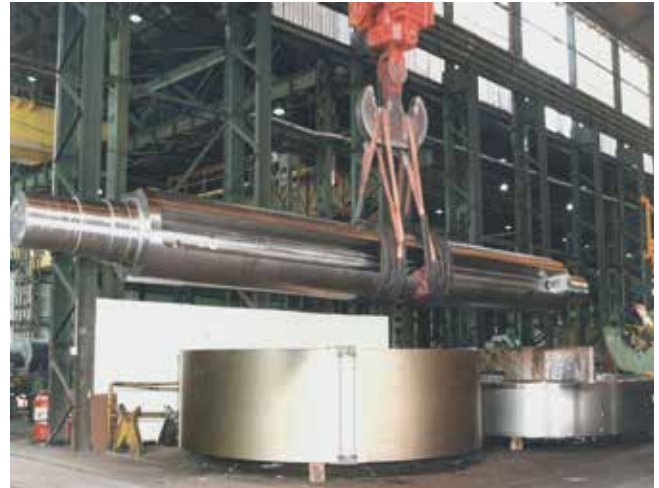
Supercalenders Ejes para la industria papelera
