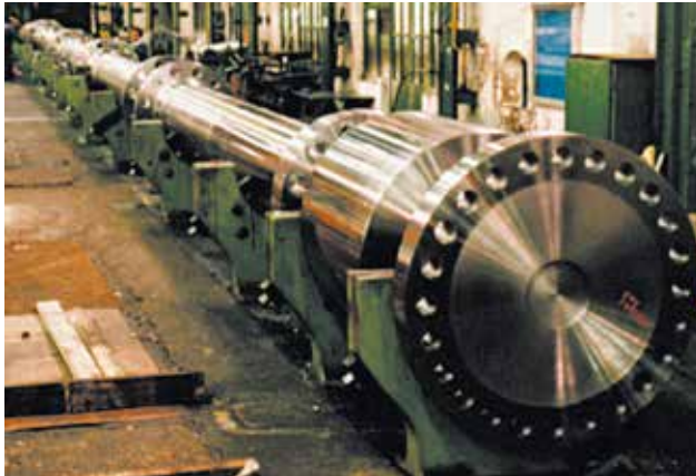
Shaft line Línea de ejes
