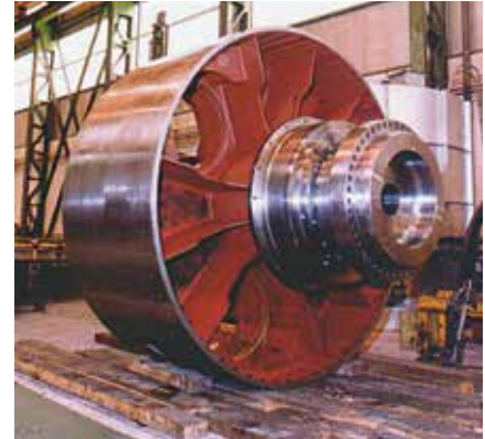
Rotor shaft Rotor eólico
