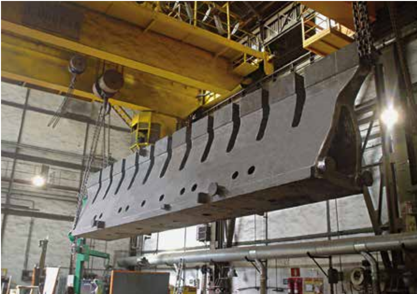
Bending press (13,2 m / 90 t) Larguero o Prensa dobladora (13,2 m / 90 t)
