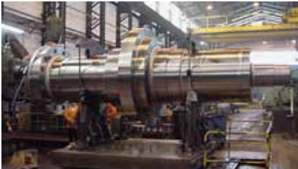
Diesel generator shaft Eje generador diesel
