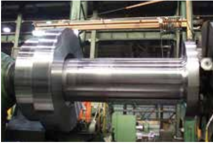
Generator shaft Eje generador
