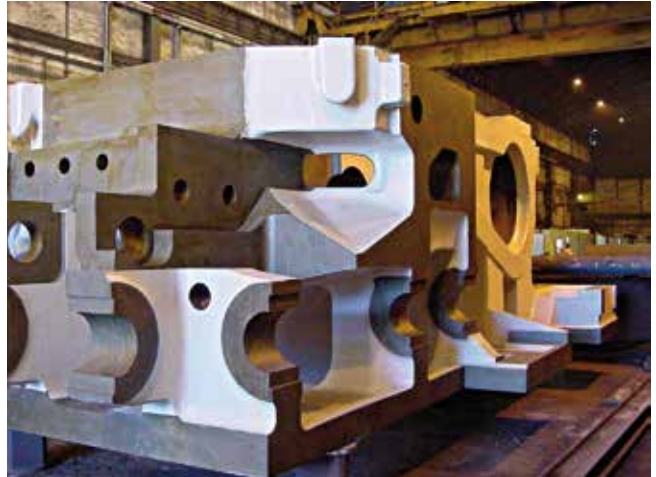
Press frame 7 x 3 x 2,3 m (98 t) Bastidor de prensa 7 x 3 x 2,3 m (98 t)
