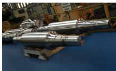
Work roll 3%Cr - 5%Cr Cilindro de trabajo 3%Cr - 5%Cr
